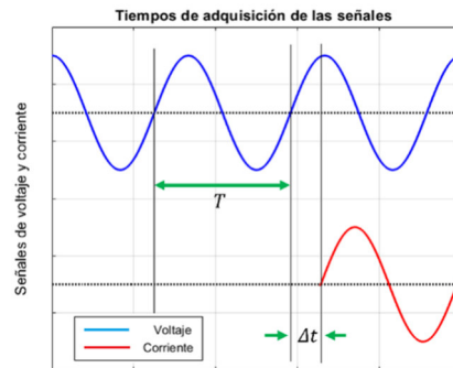
Fig. 7. Gráfica de tiempos para determinación del ángulo de fase.
