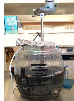
Fig. 1. Biorreactor Anaerobio RAFA de 5L de operación.
