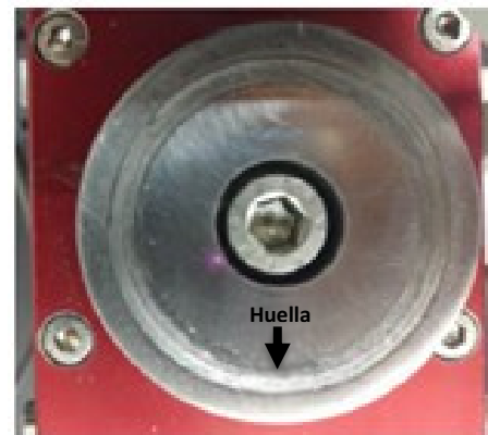
Fig. 9. Disco después de la prueba de desgaste.
