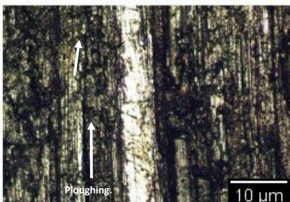
Fig. 7. Desgaste en disco de acero AISI 1018.
